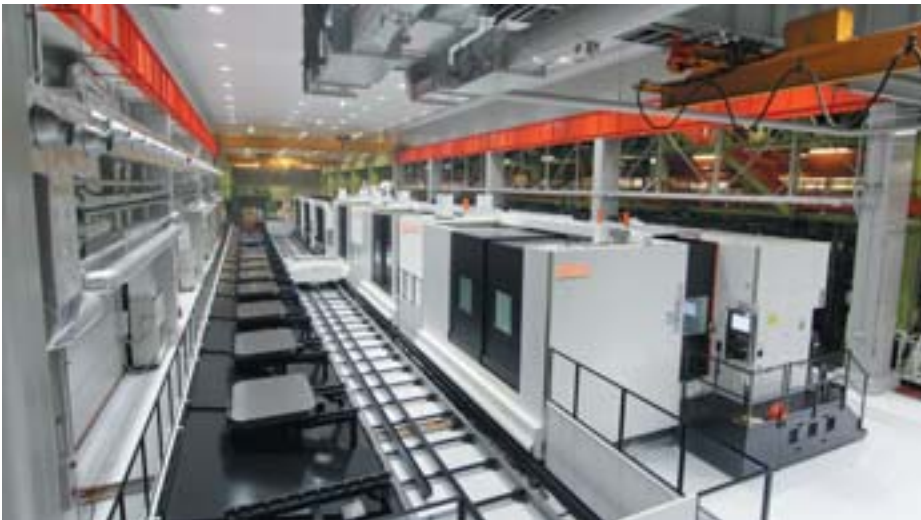
Nuovo sistema di automazione per la lavorazione di componenti di grandi dimensioni (stabilimento di Oguchi, Giappone)
