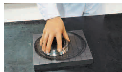
Lappatura: finitura di precisione delle facce dei distanziali su una lappatrice
