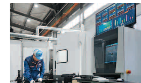
Il monitor Smooth Monitor AX (in alto a destra nell'immagine) facilita la condivisione dello stato operativo della macchina
