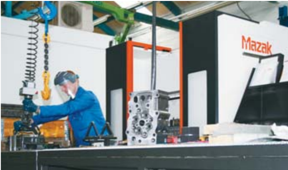
Maschinenbediener bei der Entnahme eines komplexen Kolbenkopfes aus einer der neuen Maschinen des Typs HORIZONTAL CENTRE NEXUS 6000-II bei John Hyde Engineering
