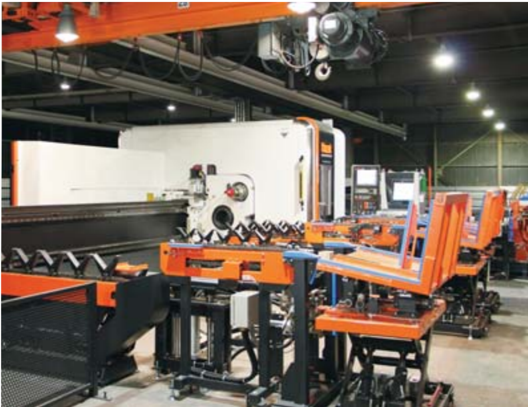
Von Korenaga Shoukai für die 3D FABRI GEAR 220 II entwickeltes Beschickungs- und Beladesystem
