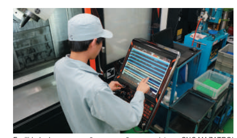
Facilidade de programação e operação com o sistema CNC MAZATROL
