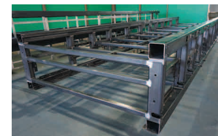
即席麺プラントのフレームは、マザックの3次元レーザ加工機で高効率に加工
