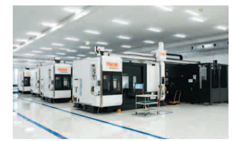
FMS-Fertigungsstraße mit Maschinen der Serie INTEGREX i in der Sankyo Dream Factory
