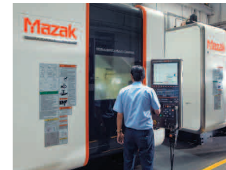
Le nombre d'étapes nécessaires pour l'usinage des moules a été réduit grâce aux centres d'usinage 5 axes
