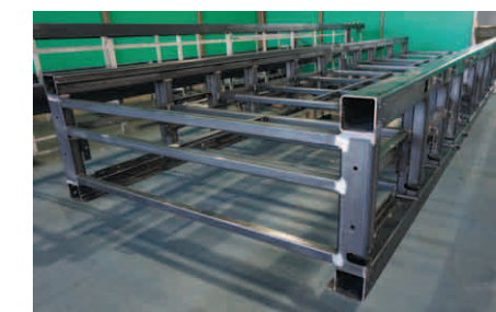
Les châssis des machines à nouilles sont découpés avec efficacité par des machines laser 3D Mazak
