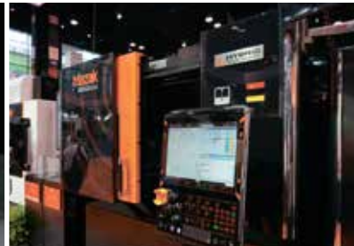
VC-500 AM, первый гибридный многозадачный станок Mazak, выпускаемый в Соединенных Штатах
