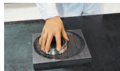
在抛光盘上对垫片端面进行打磨的抛光作业
