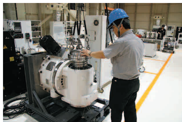
设置在试运转台上的主轴箱,即使是修理品,发货时也进行与新品同等的品质检查
