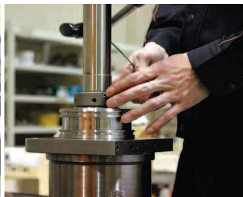
熟练工程师进行主轴安装作业
