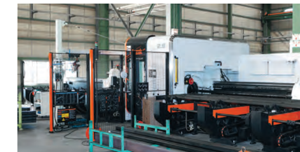
3D FABRI GEAR 220 II usada para corte 3D de tubos de aço
