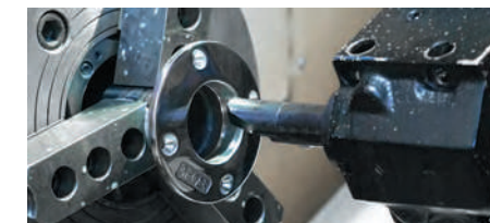
Usinagem de acabamento do interior de um componente de fundição por cera perdida
