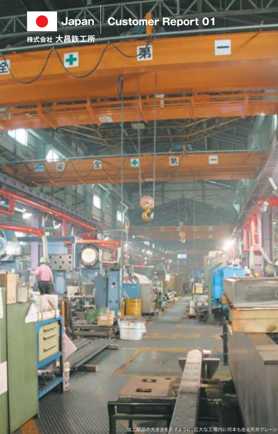
加工部品の大きさを示すように、広大な工場内に何本も走る天井クレーン
