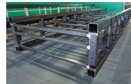
"As armações das máquinas de macarrão instantâneo são cortadas pelas máquinas de processamento a laser 3D da Mazak com entrada
