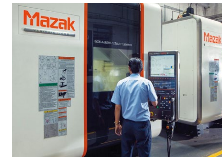
O número de etapas para fabricação de moldes foi reduzido com centros de usinagem de 5 eixos
