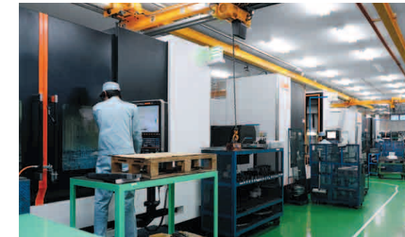
Präzisionsbearbeitung mit hoher Geschwindigkeit auf vertikalen Mazak-Bearbeitungszentren
