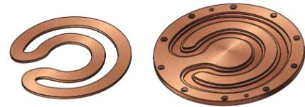
バックリングプレートは半導体、液晶パネル等の製造工程で使用される成膜（スパッタリング）装置に用いられる。真空チャンバ（真空の環境を作る容器）の中で、ターゲット材\*と呼ばれる金属インゴットの保持を担う。ターゲット材は化学反応により高温となるため、冷却水の流路も必要となる。
