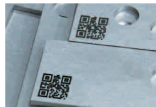
レーザ加工機によるQRコードの刻印
