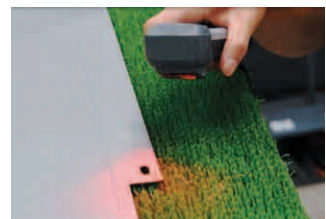
作業者は刻印されたQRコードを読み込むことで、曲げ工程などにおいて加工プログラムを呼び出す
