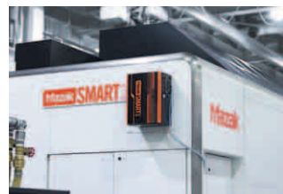
機械加工エリアの各所に配置されたMAZAK SMARTBOX™により、設備機のあらゆるデータを収集
