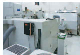
旧型の設備機や周辺機器の情報は、MAZAK SENSOR BOXを経由して収集
