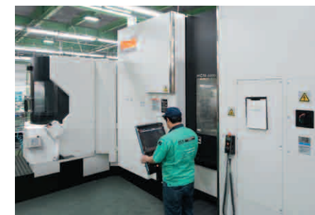
長時間無人加工可能な6パレットチェンジャ付き マザック横形マシニングセンタHCN-6000
