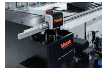
複数台の設備機に対して工具を自動供給 (写真: ツールトランスポートシステム)
