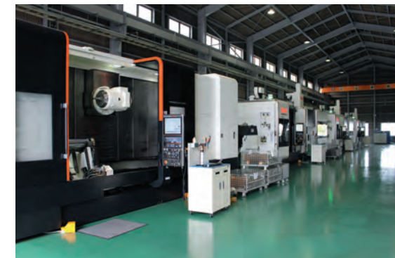
Линия обработки, состоящая из станков серии INTEGREX для изготовления основных компонентов GUZZILLA
