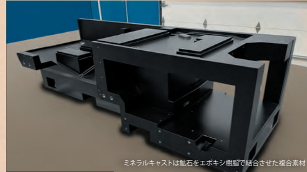
ミネラルキャストは鉱石とエポキシ樹脂で結合させた複合素材
