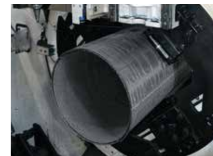
Роликово - зажимная система с четырьмя кулачками позволяет фиксировать детали даже с тонкими стенками
