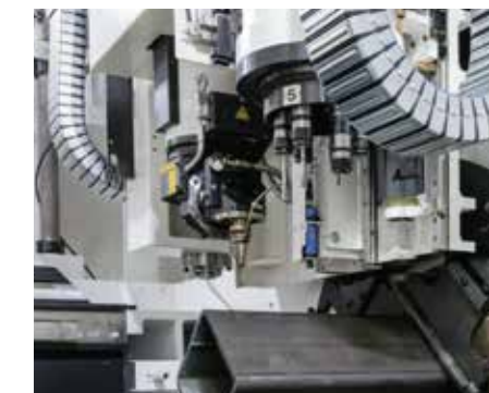
Резьбонарезное устройство и сенсорная система измерения расположены рядом с резаком
