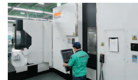
Mazaks horizontales Bearbeitungszentrum HCN-6000 mit 6fach Palettenwechsler läuft über lange Zeiträume im unbemannten Betrieb
