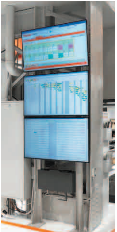
Großbildschirme im Montagebereich zeigen den Fortschritt der laufenden Prozesse in Echtzeit an
