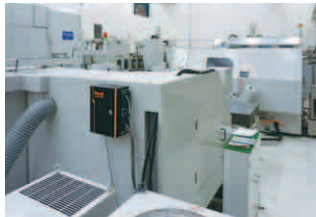
Informationen älterer Maschinen werden durch die MAZAK SENSOR BOX gesammelt
