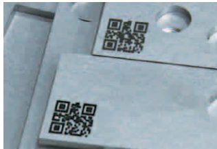
QR-Codes* werden mit einer Laserschneidmaschine eingraviert *QR-Code ist eine eingetragene Marke der Firma DENSO WAVE INCORPORATED
