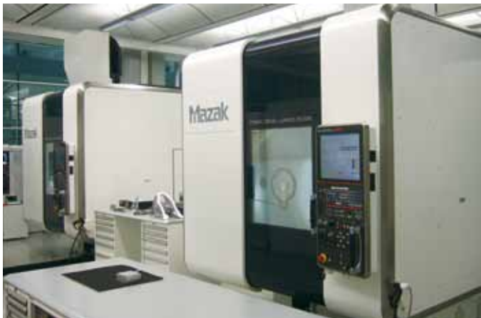
Два станка HYPER VARIAXIS 630, применяемые для обработки деталей гоночных автомобилей
