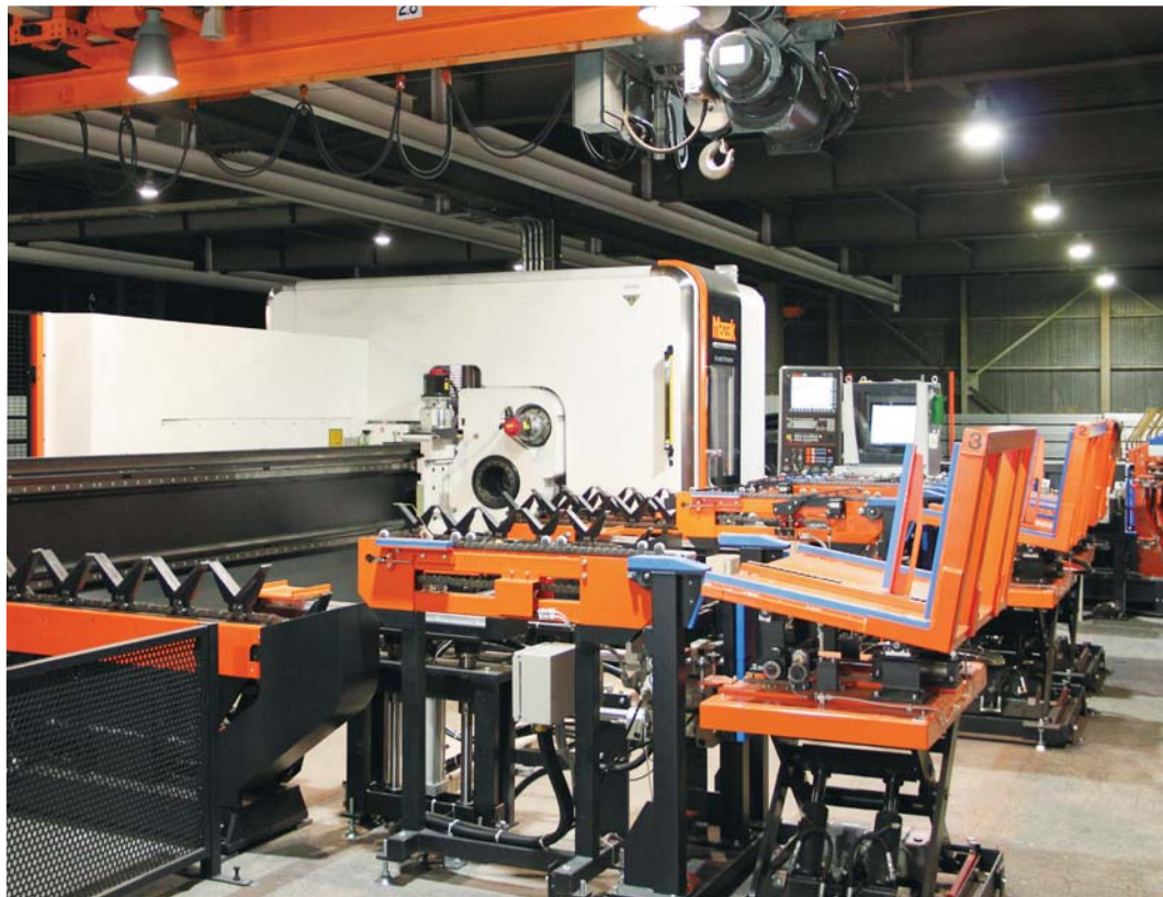
Система подачи/загрузки заготовок, разработанная Korenaga Shoukai для станка 3D FABRI GEAR 220 II
