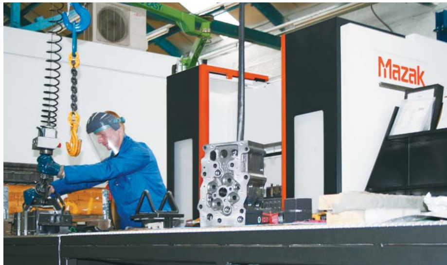
Оператор снимает сложную поршневую головку, сделанную на горизонтальном обрабатывающем центре HORIZONTAL CENTRE NEXUS 6000-II, недавно приобретённом John Hyde Engineering.
