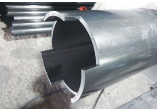
Стальная труба, изготовленная на станке 3D FABRI GEAR 220 II
