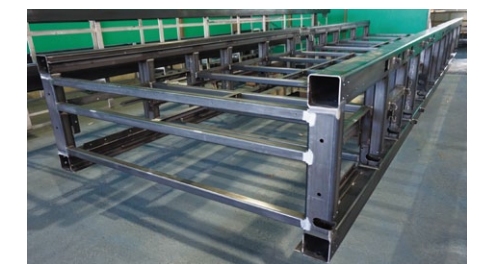
Корпус оборудования по производству лапши быстрого приготовления, вырезанный на высокоэффективном 3D лазерном станке Mazak
