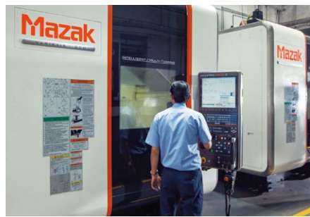
Количество этапов процесса обработки было сокращено благодаря 5-осевым обрабатывающим центрам
