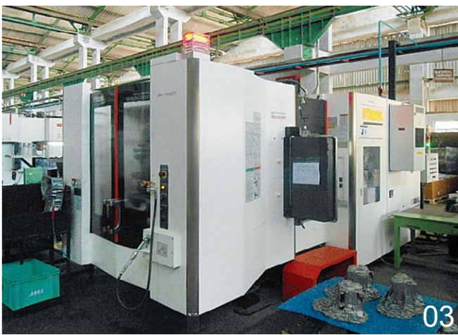
01. Множество станков Mazak используются на заводе Akurdi 02. Высокоскоростная и высокоточная обработка, выполняемая станками серии VARIAXIS i 03. Горизонтальный обрабатывающий центр серии HCN, используемый для чистовой обработки отливок
