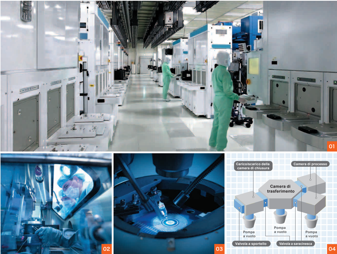
01. Stabilimento di ultima generazione (camera bianca) con file di impianti per la produzione di semiconduttori (Foto: Toshiba Memory Corporation) 02. Manipolazione in una glovebox, per impedire l'ingresso di ossigeno e acqua 03. Test elettrico di una fetta di silicio 04. Schema delle camere a grappolo nello stabilimento di produzione
