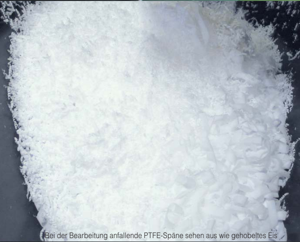
Bei der Bearbeitung anfallende PTFE-Späne sehen aus wie gehobelltes Eis
