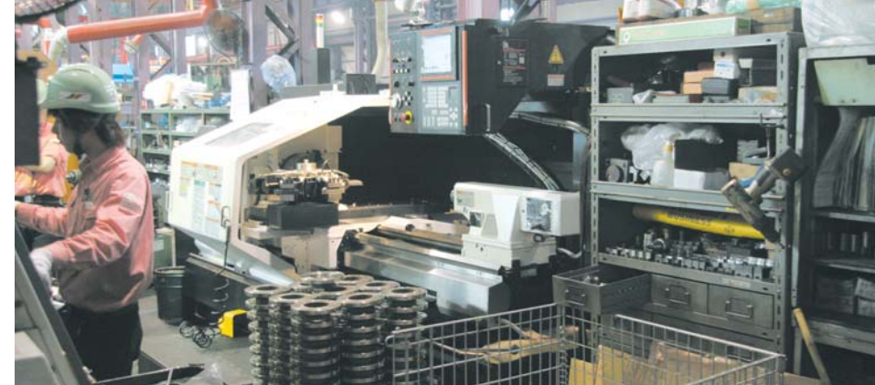
M4 (1500U) für die hocheffiziente Bearbeitung großer und langer Werkstücke
