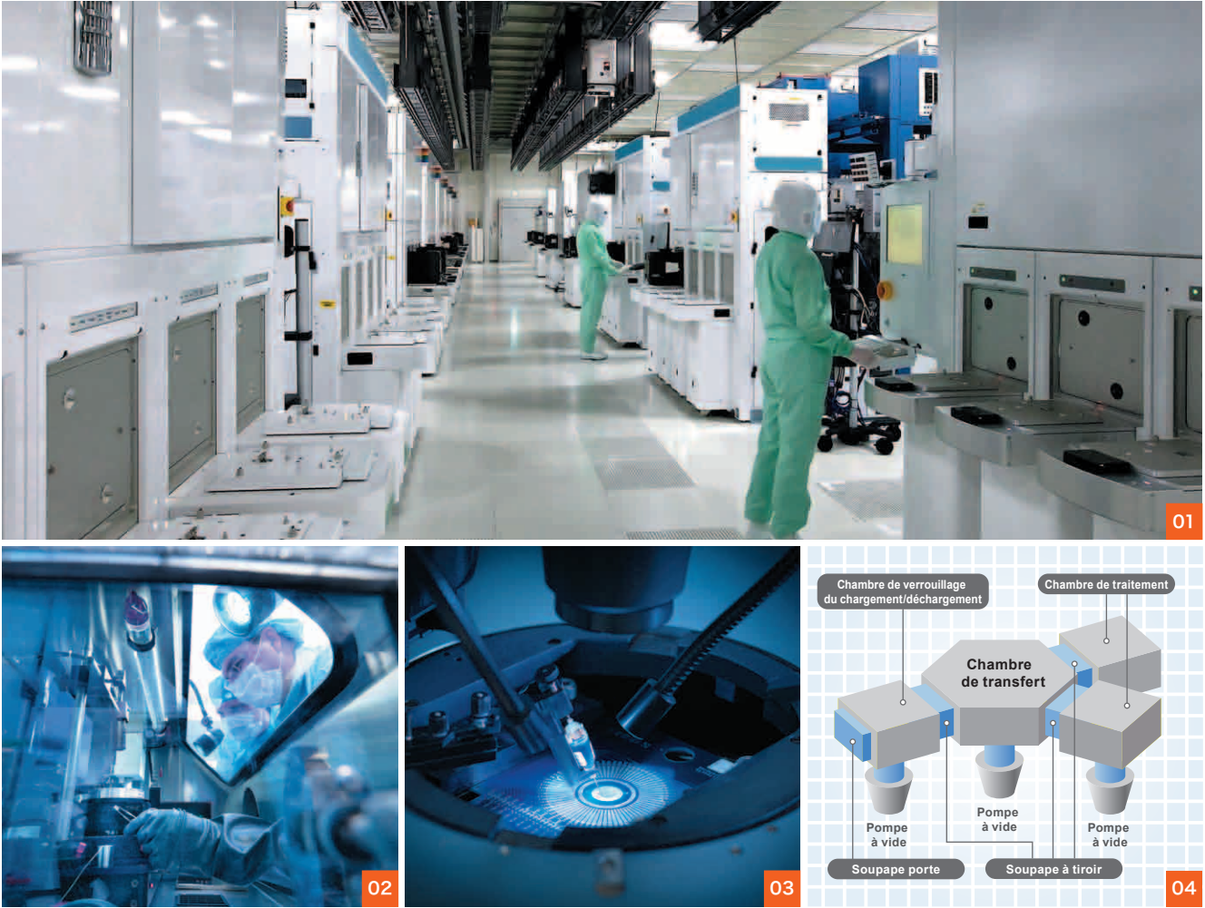
01. Usine de semi-conducteurs de pointe (salle blanche) avec des rangées d'équipements de fabrication de semi-conducteurs (photo avec l'autorisation bienveillante de Toshiba Memory Corporation) 02. Opération réalisée dans un caisson qui bloque le flux d'oxygène et d'eau 03. Essai électrique d'une plaquette de silicium 04. Schéma des différentes chambres dans les équipements de fabrication
