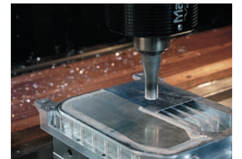
铝制冷却板的高速搅拌摩擦焊
