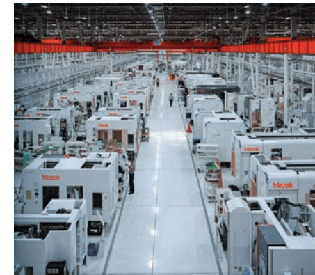
通过采用LED照明、最新的空调和能源管理系统,美浓加茂制作所第一工厂的CO 2 排放量减少了大约30%
