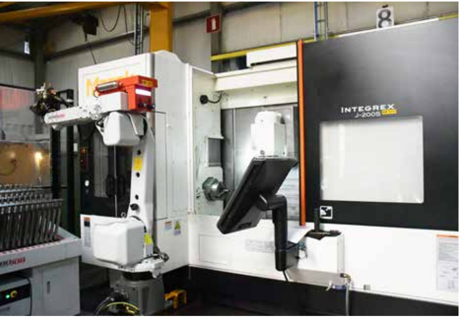
Wie complexer werk zegt, kan niet om vijfassige machines heen. Met een Integrex J200S, de drukt bezette machine op de werkvloer, en de VTC 800-30SR beschikte Aelbrecht Maes al over diverse mogelijkheden voor vijfassig.
