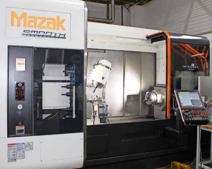
Die Multifunktions-Dreh-Fräsmaschine Integrex I400s hat einen Stangendurchlass von 103 mm.
